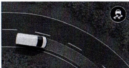
controle de estabilidade (ESP) e controle adaptativo de carga (LAC) O ESP corrige a trajetória do carro para evitar derrapagens. O controle adaptativo de carga identifica o deslocamento da carga e o centro de gravidade do veículo para otimizar a eficiência da frenagem, a tração e a estabilidade.
